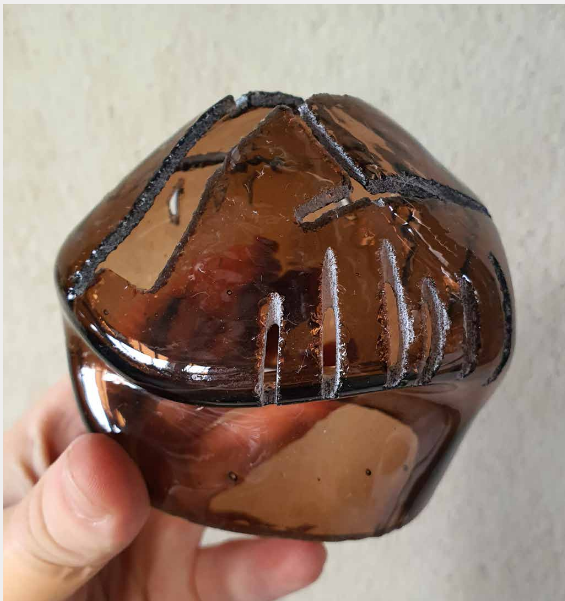
Klaastahvlist rullitud toorik, millesse saagisin lõiked, hiljem võtsin soojendatult uuesti piibule ja rullisin läbipaistva kihi peale
