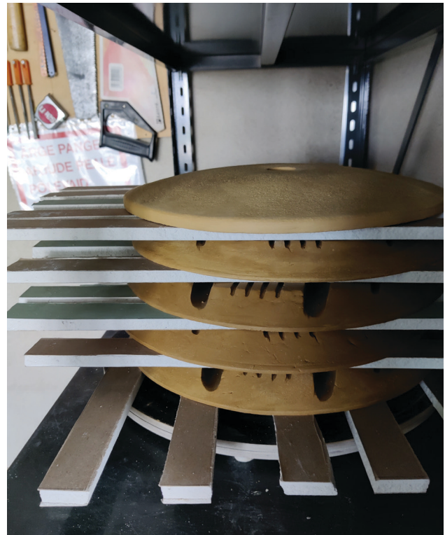
ill 25. Ketaste kuivatamine ja ahju pakkimine sundkuivatamiseks
