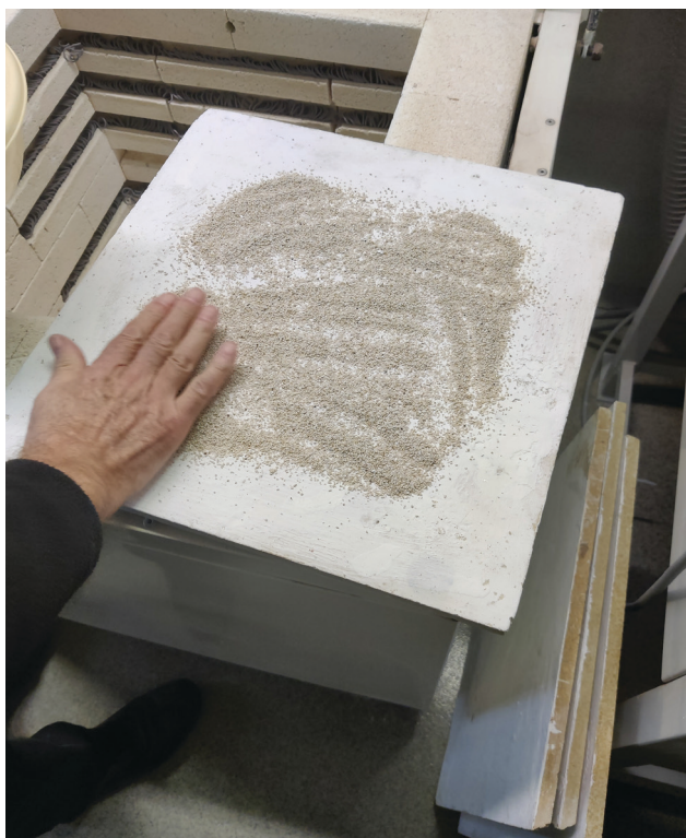
ill 27. Ahjuplaadi katmine šamotiga, ahju pakkimine ja õnnestunud kettad
