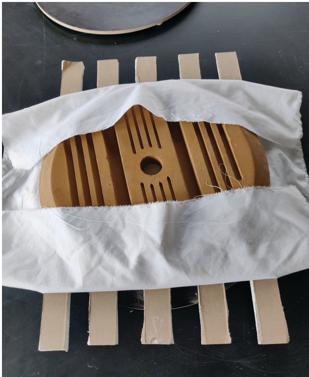
ill 25. Ketaste kuivatamine ja ahju pakkimine sundkuivatamiseks
