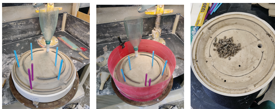
ill 20. Õhukanalite lisamine ja kipsvormi puhastamine savist
