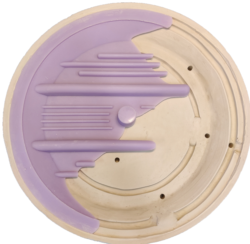
ill 21. Ebaõnnestunud katse täita vorm silikooniga
