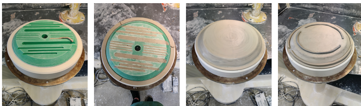
ill 19. Mudeli fikseerimine kipsplaadile ja katmine saviga
