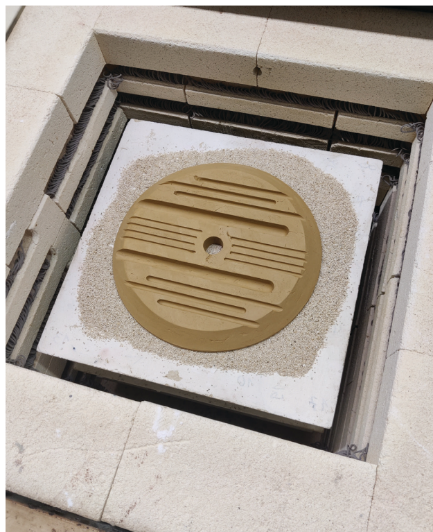
ill 27. Ahjuplaadi katmine šamotiga, ahju pakkimine ja õnnestunud kettad
