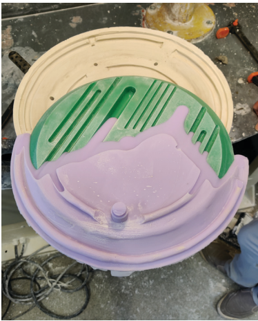
ill 21. Ebaõnnestunud katse täita vorm silikooniga
