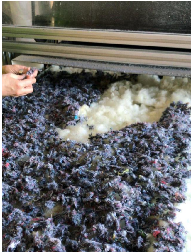
Foto 37: T-särgi tekstiilimassi laotamine kraaslindile. Autori foto.
