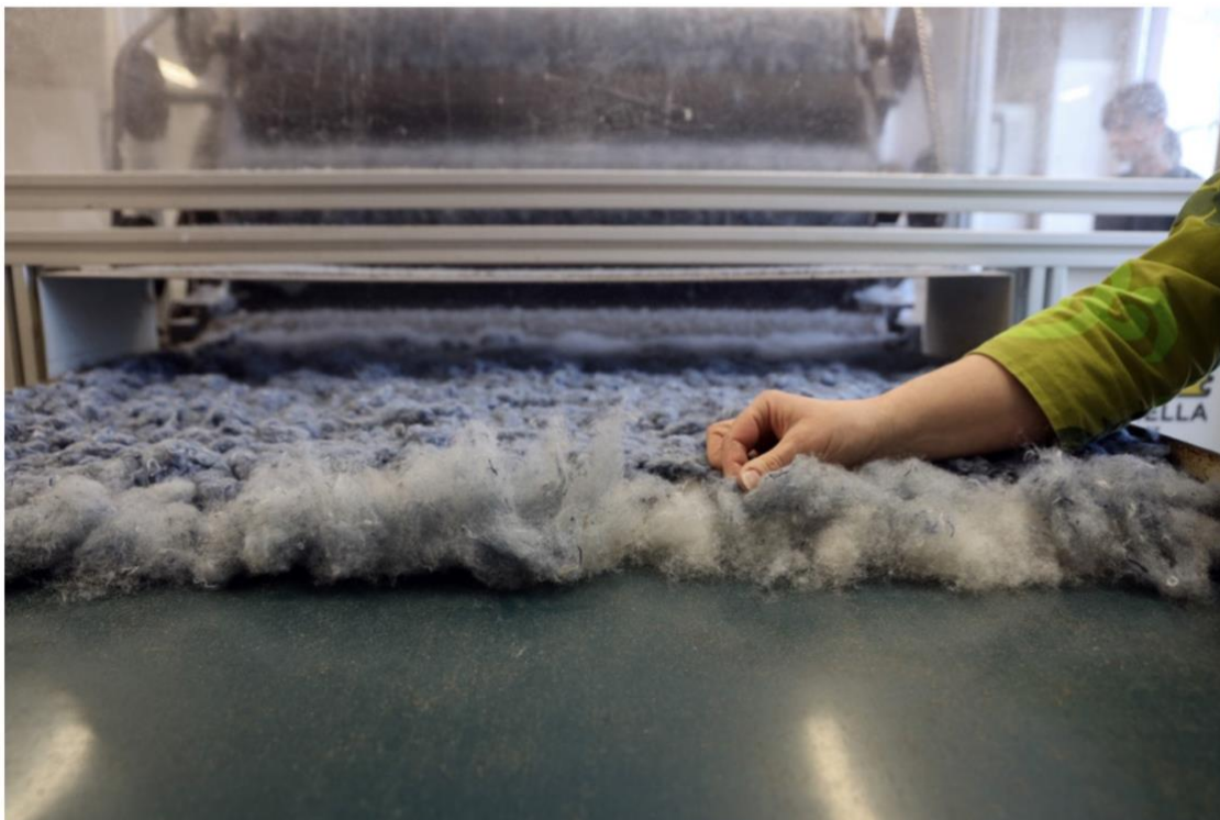
Foto 16. Vill ja ümbertöödeldud teksakiud liikumas kraasiliinil kraasimismasinas
