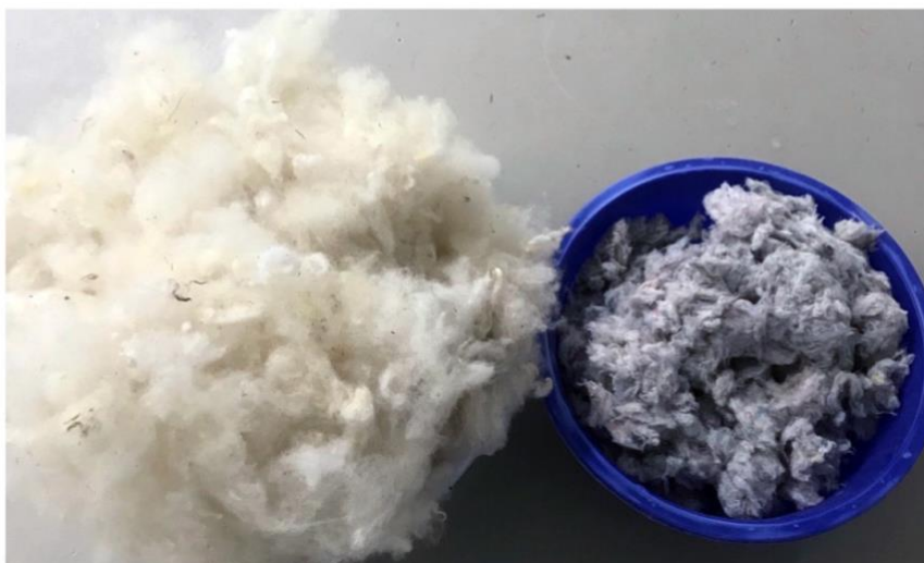
Foto 15. Pestud lambavill ja puhastatud ümbertöödeldud teksakiud
