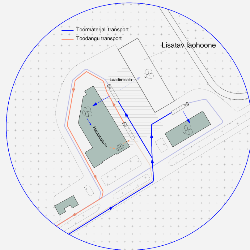
Joonis 46: Kanepitööstlustehase transpordiskeem (autor Looa Orav)
