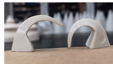
21. Temperatuuri näitavad koonused, nr 6. Vasakpoolne oli laboriahjus, parempoolne suure ahju keskmisel riulil.
